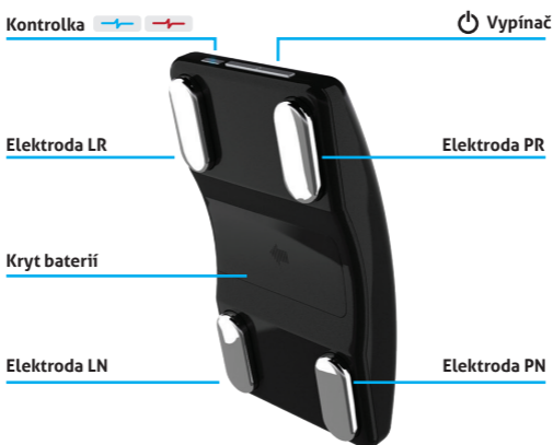
Obr. 1 ISTELE HR-2000 zařízení pro domácí monitorování EKG
